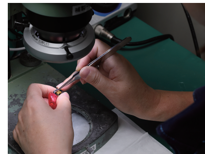
耳あな型補聴器の製造現場。1ミリ以下の精度の設計に基づいて、細かな精密部品を手作業で組み込んでいく
